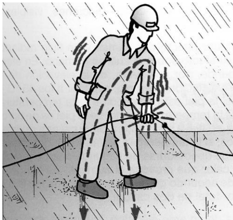
Contacto eléctrico directo. Paso de la corriente a través del cuerpo
