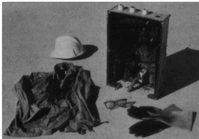
Efectos visibles del arco eléctrico
