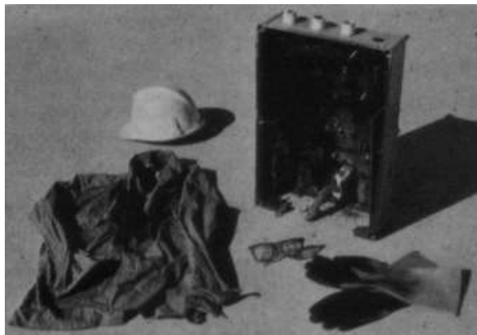
Efectos visibles del arco eléctrico
