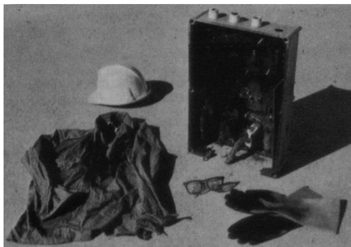
Efectos visibles del arco eléctrico
