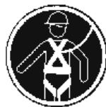
Protección individual obligatoria contra caídas
